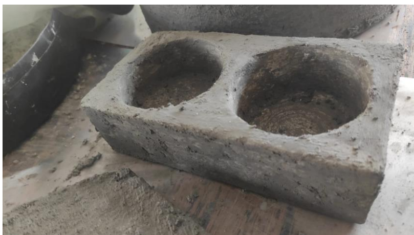
Figura 8 - Peça produzida em Papercrete .
