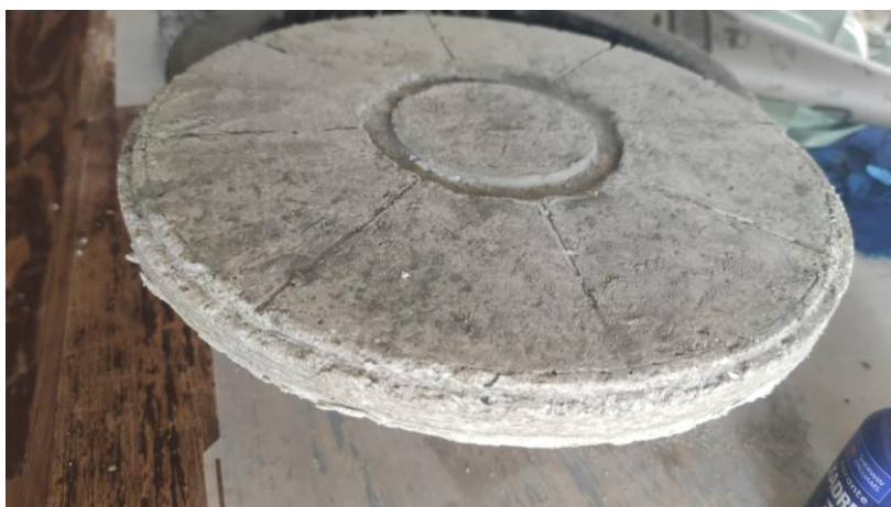
Figura 9 - Peça produzida em Papercrete .
