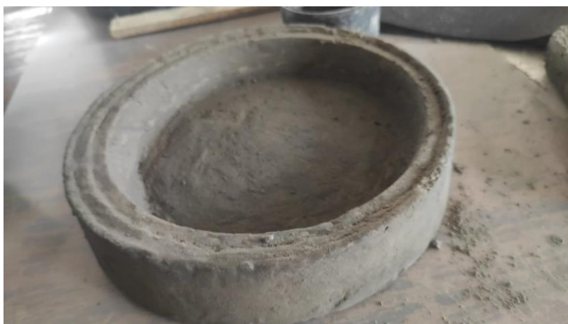
Figura 6 - Peça produzida em Papercrete .
