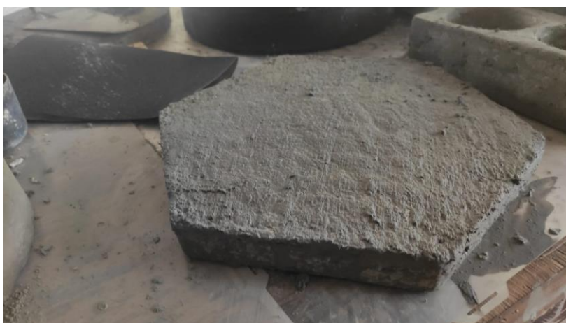
Figura 7 - Peça produzida em Papercrete .
